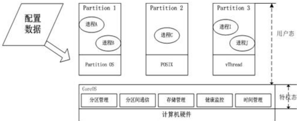
图 3-1 具有分区能力的操作系统架构
